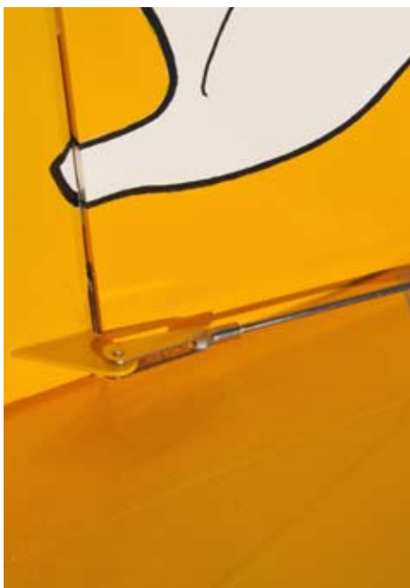
Sidrodret styrs liksom höjdrodret med en stötstäng gjord av 1,5 mm pianotråd och en 5 mm hård balsalist.
