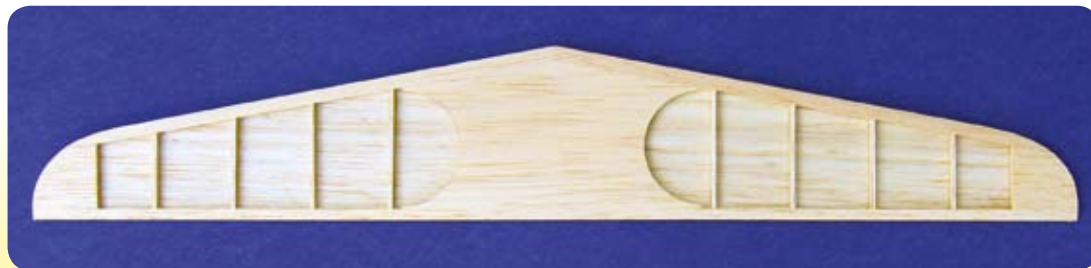
Stabilisatorn byggs enkelt direkt på plankningen. Här är det bara översidan av 1,5 mm balsa som saknas.
