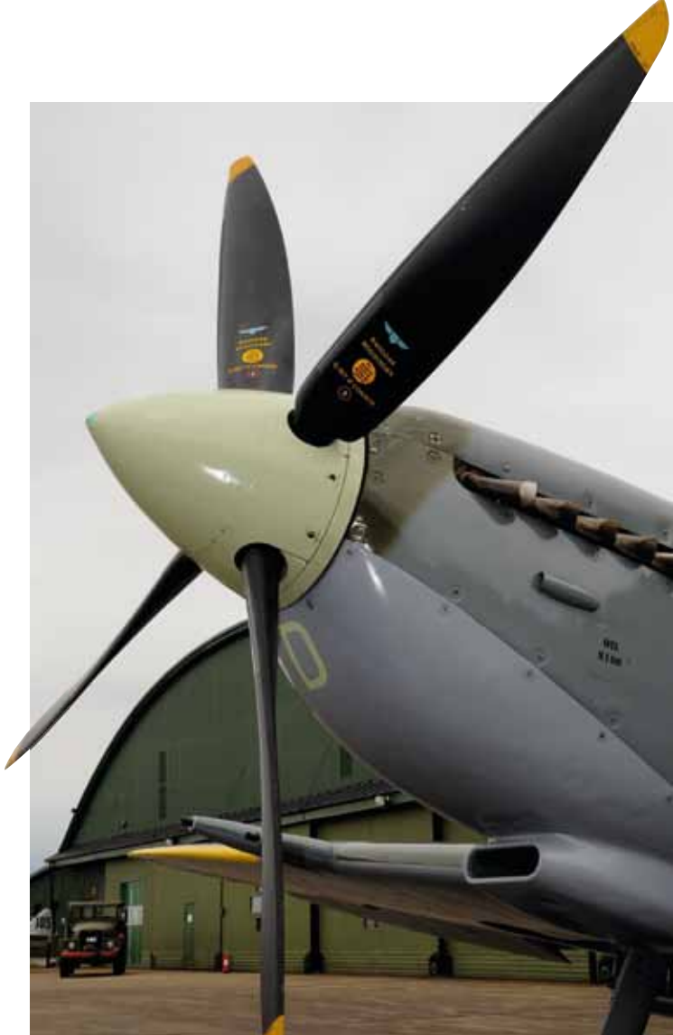
Mk XVI har liksom Mk IX en fyrbladig Dowty Rotol-propeller med den imponerande diametern av 3,27 meter. Bladens kärnor är faktiskt gjorda av trä!
