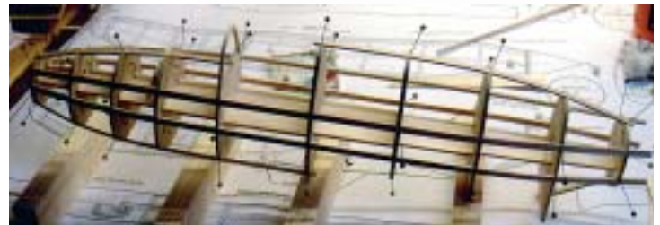
Ovan: J21an sedd rakt ovanifrån. Nedan: Det är ett riktigt spantbygge.
