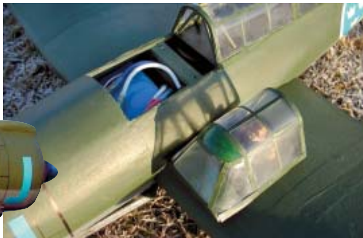
Främre delen av huven är löstagbar och därigenom finns möjlighet att komma åt och ladda acken utan att vingen behöver skruvas bort. På bilden syns den 2x1,5Ah Lipo-ack vi använde i testmodellen.
