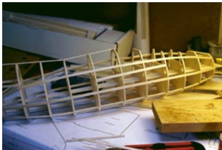
Spanten uppträdda på sina fixturkivor och listarbetet påbörjat.
